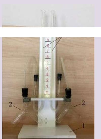
соединяются с сосудами Ландольта с помощью пластиковой трубки с пробками (рис. 5). Между манометрическими трубками на панели нанесена шкала для наблюдения уровня жидкости в трубках. Окрашенной жидкостью может быть раствор любого красителя в воде.
