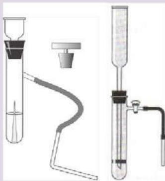
Рис. 7. Прибор для получения и собирания газов
